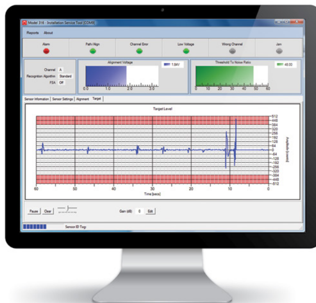
Pantalla de Blanco – Detección de Blanco- Alarma
